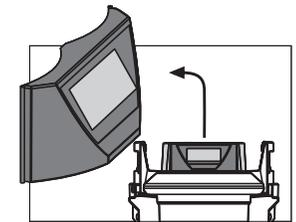
6. Anzeigeeinheit bitte nach oben abnehmen. **Hinweis:** das digitale Display ist bei Auslieferung im Stand-by Modus.
