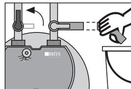
9. Absperrhahn am Wasserzulauf öffnen, dabei Spülschlauch festhalten.
