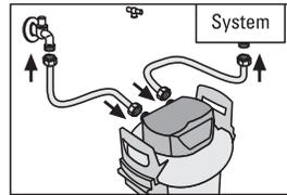
2. Anschließen der Schläuche an Armatur des Druckbehälters.
