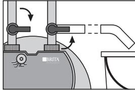
1. Absperrhahn Wasserzulauf schließen.
