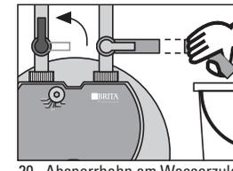
20. Absperrhahn am Wasserzulauf und am Eckventil öffnen, dabei Spülschlauch festhalten. Spülmenge mind. 10 l in **horizontaler Lage!** Absperrhahn schließen.
