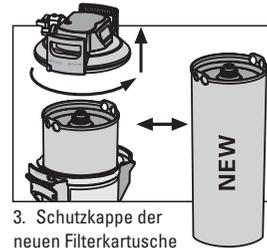
3. Schutzkappe der neuen Filterkartusche entfernen und Kartusche wechseln.
