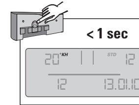
10. Durch kurzes Drücken gelangt man in die Wasserhärte-Einheit-Einstellung<sup>2</sup>.
