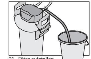
21. Filter aufstellen, Absperrhahn öffnen, nochmals Spülen, Spülmenge mind. 10 l in **vertikaler Lage.**
