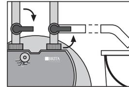
3. Absperrhahn Wasserzulauf schließen. **Spülhahn öffnen und geöffnet lassen.**
