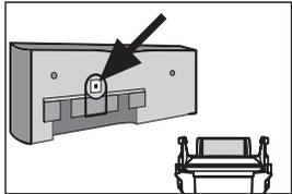
7. Auf der Rückseite der Anzeigeeinheit befindet sich der Programmierbutton. Durch Drücken der Taste wird Stand-by Modus aufgehoben.
